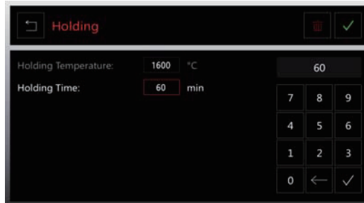
06 계류 단계의 경우 최종 목표 온도가 자동으로 고려됩니다. 원하는 계류 시간만 지정할 수 있습니다.
